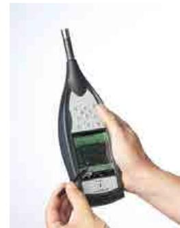
Figure 6. Sonomètre de marque Brüel et Kjaer.
